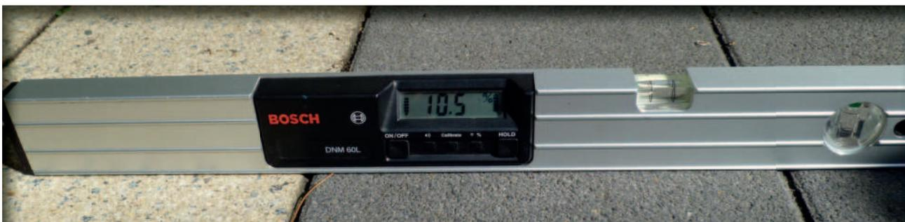
Steigungsmesser zur Überprüfung der Prozentzahl einer Steigung
